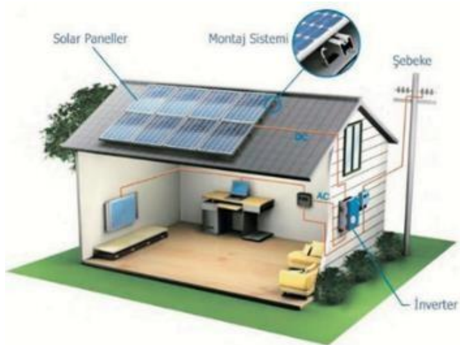
Resim: 2.1: Fotovoltaiik güneş sistemi (on grid)
