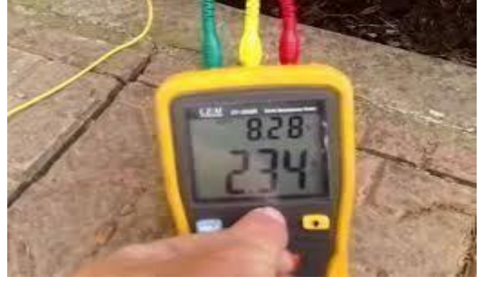
Fotoğraf 1.6: Meger kazık bağlantısı ve direnc ölçümü
