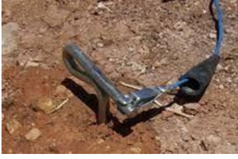
Fotoğraf 1.6: Meger kazık bağlantısı ve direnc ölçümü
