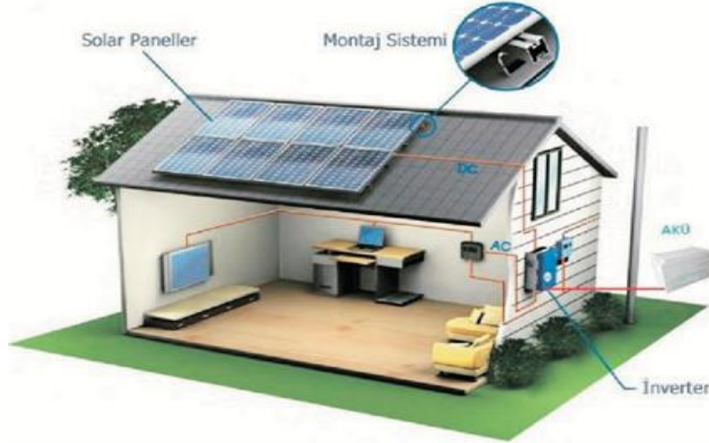
Resim: 2.2: Fotovoltaik güneş sistemi (on grid)
