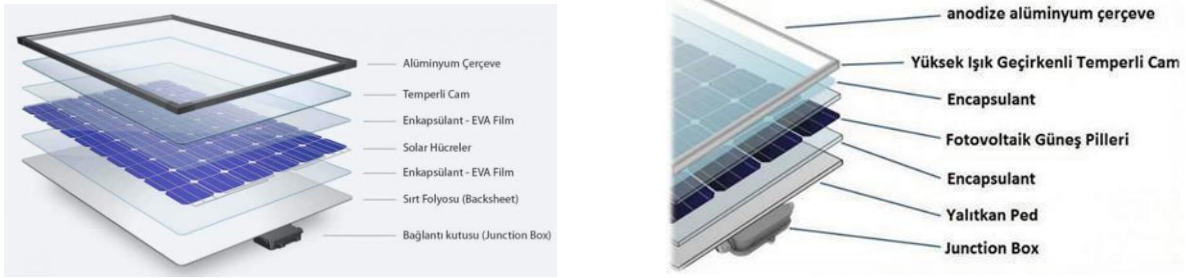
Resim 2.1:Güneş panelinin yapısı
