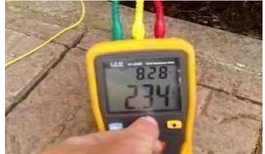
Fotoğraf 1.6: Meger kazık bağlantısı ve direnc ölçümü
