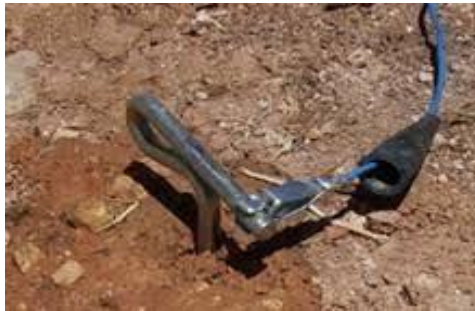
Fotoğraf 1.6: Meger kazık bağlantısı ve direnc ölçümü
