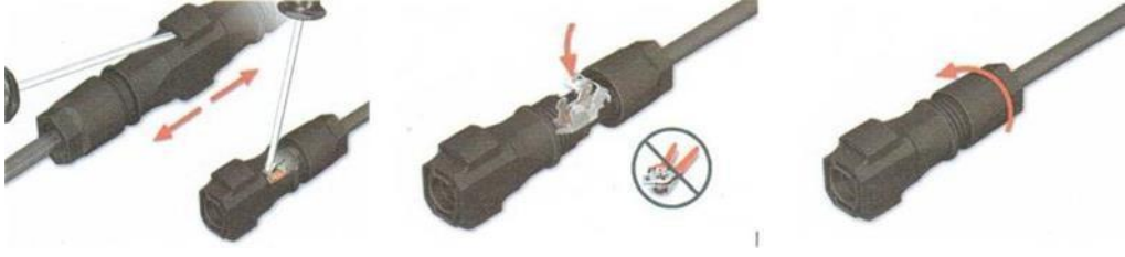
Resim1.4:Özel alet gerektirmeyen bağlantısı yapılabilen bir soket türü
