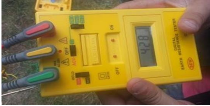
Resim 3.1: Dijital topraklama direnç ölçüm meger cihazı
