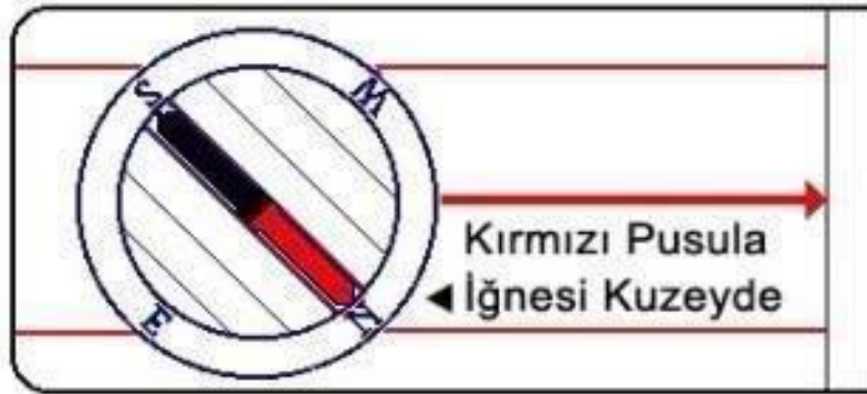
Şekil 4.3: Pusula iğnesinin kuzeyi ile pusula yuvasının içindeki kuzeyi çakışana kadar dönüş
